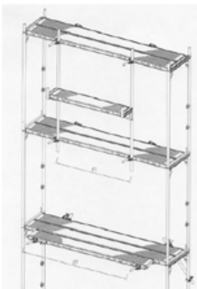
Rys. 11 Poszerzenie powierzchni roboczej za pomocą pomostów Layher
