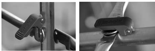
Uchwyt mocujący: a – otwarty sygnalizuje o niezabezpieczonej poręczy; b – zamknięty
