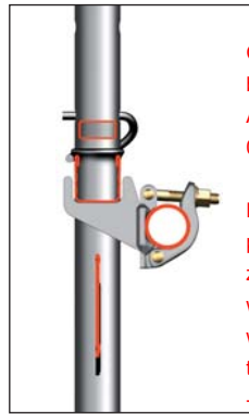
Rys. 41: Przekrój złącza kotwiącego
