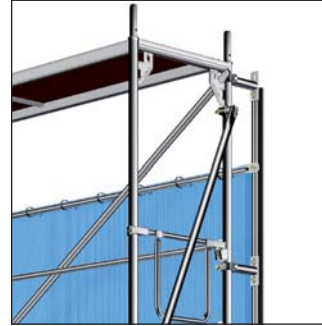
Rys. 118: Przykład zabudowy systemu plandek kederowych z wzmocnieniem
