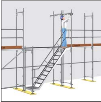
Rys. 53: Połączenie z rusztowaniem głównym
