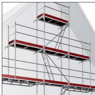
Rys. 83: Redukcja długości pola
