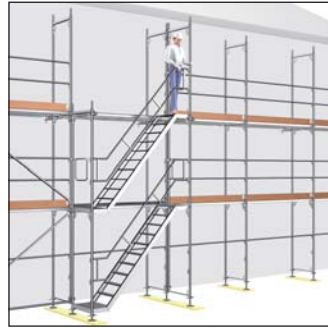
Rys. 54: Montaż poręczy schodów
